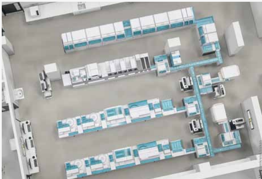
Automationskonzept im Zentrallabor Minden: Prä- und Postanalytik mit cobas 8100; Klinische Chemie und Immunologie mit 2x cobas 8000; Hämatologie mit Sysmex XN 9000; Gerinnung mit 2x STA-R Max
